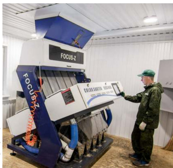
Для качественной очистки семян работают три семенные линии с оптическими сортировщиками, что позволяет добиваться 99,9% чистоты продукта
